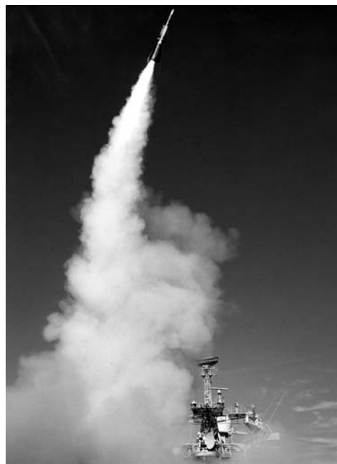
Missile antiaérien Aster 15 naval : longueur 4m ; diamètre 0,18 m ; poids 300kg. Sources : http://aeroproject.free.fr
